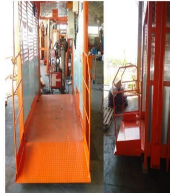
Rampa de Acesso ABAIXADA
