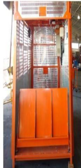
Rampa de Acesso LEVANTADA
