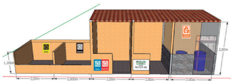
FIGURA 60 EXEMPLO DE ABRIGO INTEGRADO PARA ACONDICIONAR RESÍDUOS.
